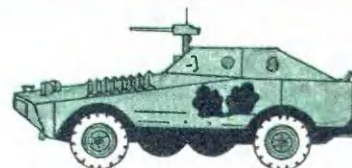
БРДМ — боевая разведывательно-дозорная машина — так называется этот бронированный автомобиль. Он отличается от БТР-40 тем, что помимо четырех основных ведущих колес имеет четыре опускающихся дополнительных (тоже ведущих) колеса. БРДМ может не только двигаться по суше, но и плавать.
