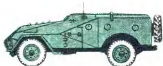
БТР-40 — представитель послевоенного поколения броневых колесных машин. О его назначении можно судить по наименованию: это уже не бронеавтомобиль, а бронетранспортер. У БТР-40 несущий корпус, привод на все колеса, низкий профиль. Двигатель, трансмиссия, узлы шасси заимствованы от автомобиля повышенной проходимости.
