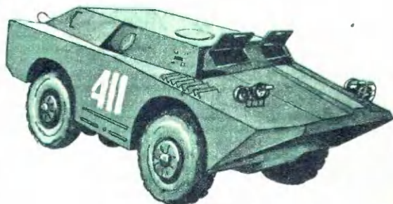
БРДМ-2 представляет собой усовершенствованный вариант БРДМ. Он сохранил его восьмиколесную схему, способность плавать и другие преимущества и приобрел более мощный двигатель, который располагается не в носовой, а в кормовой части машины.
